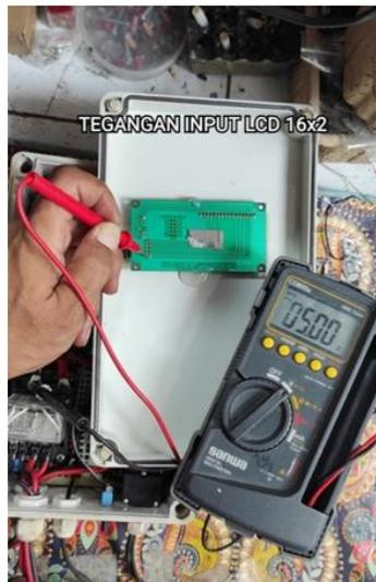
Gambar 6. Hasil pengujian LCD 16x2
