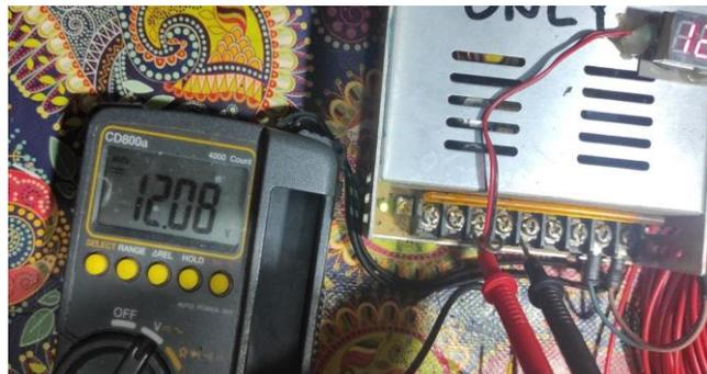
Gambar 4. Proses Pengujian Tegangan *Output* Adaptor
