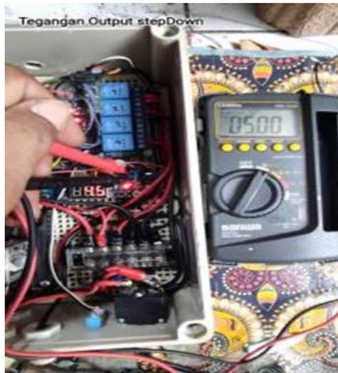
**Gambar 5. Hasil pengujian rangkaian step down 5 Volt DC.**
