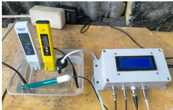
**Gambar 6** Pengujian dengan Alat Ukur Pembanding
