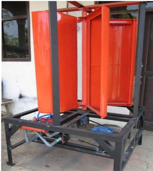
Gambar 3. Turbin Savonius dengan 3 blades.
