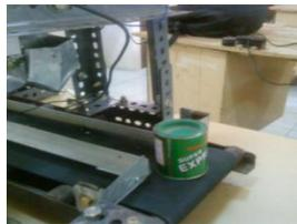
Gambar 10 Peletakkan kemasan pada konveyor berjalan
