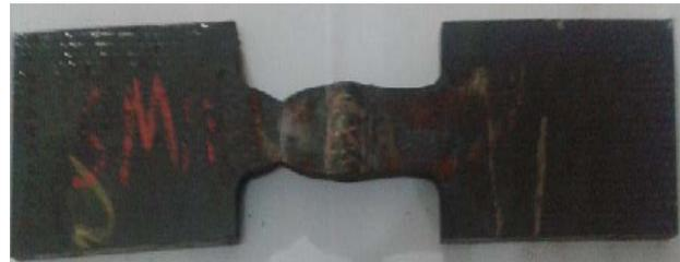
Gambar 7. Hasil Uji tarik dengan Pengelasan SMAW
