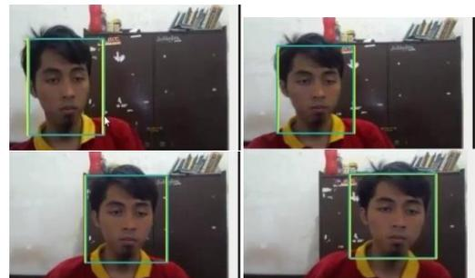
Gambar 4. Hasil pengujian algoritma Mean Shift
