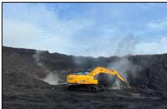
**Gambar 9.** Penanganan Swabakar Menggunakan Excavator PC200
