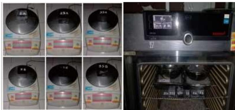
Gambar 3. Pengukuran dan Pengeringan sampel dengan oven
