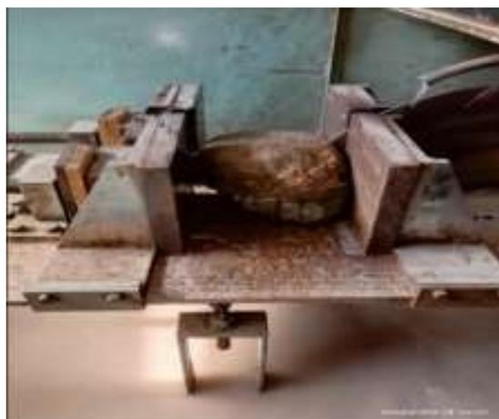
**Gambar 2.** Proses preparasi sampel atau pemotongan batu
