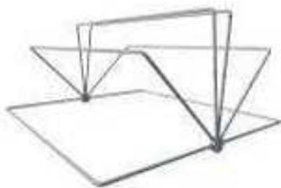
Gambar 1. Desain komponen frame jebakan model lipat
