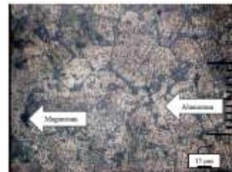
**Gambar 4.** Struktur Mikro Aluminium di *aging* 160°C
