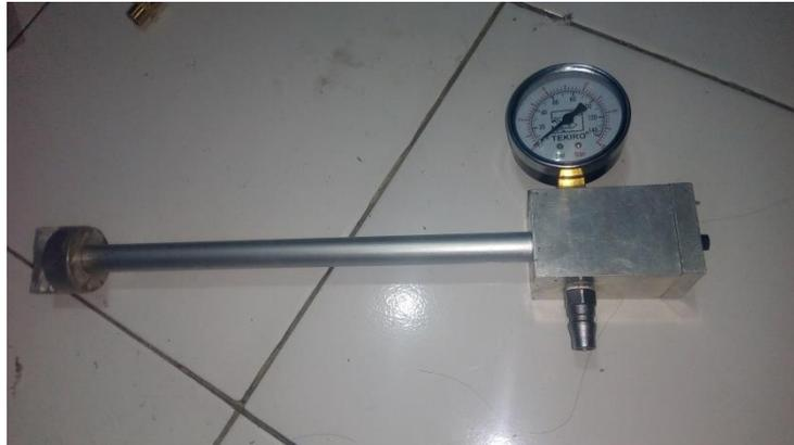
Gambar 6. Prototipe Tabung Vortex
