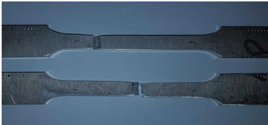
Gambar 18. Spesimen Hasil Pengujian Tarik Raw Material.
