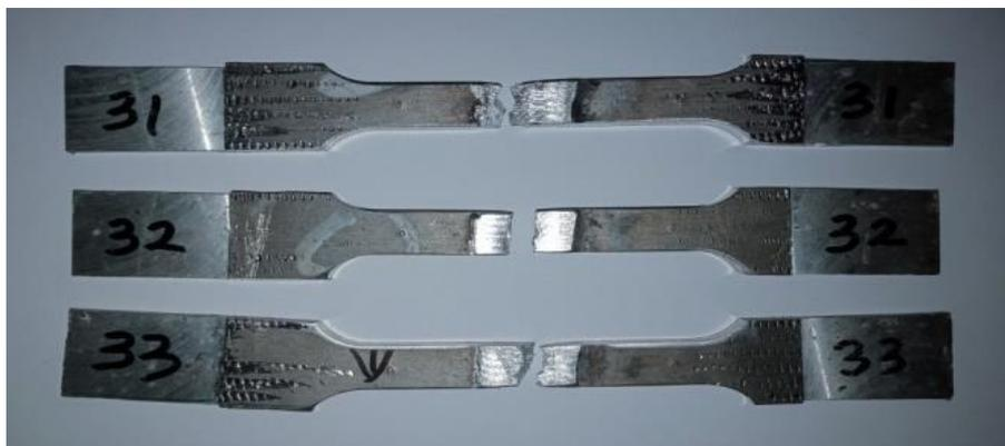
Gambar 21. Spesimen Hasil Pengujian Tarik Arus 125 A.
