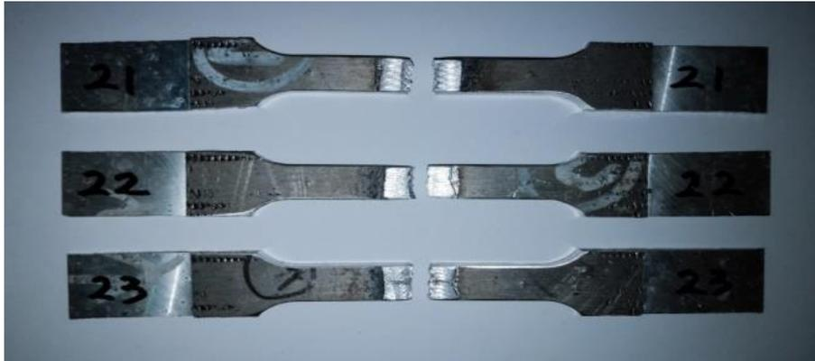
Gambar 20. Spesimen Hasil Pengujian Tarik Arus 115 A.
