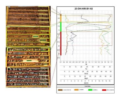
Gambar 4. Titik bor pada lubang bor 23-DH-HIR-B1-02
