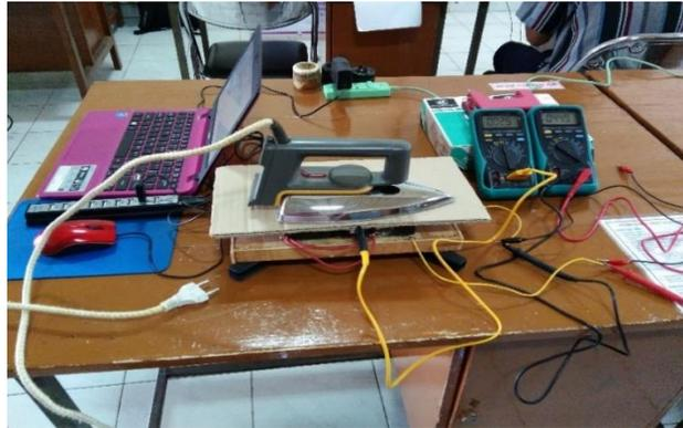
**Gambar 9.** Proses pengujian *Thermoelectric Generator* Al dan C
