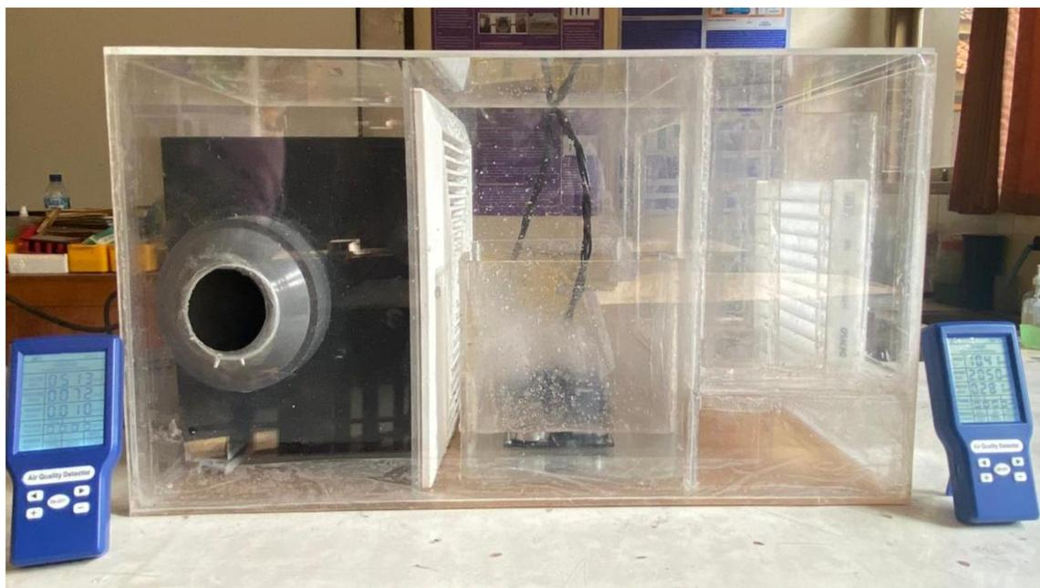
**Gambar 3.** Mesin ventilasi udara mekanik dengan filter bio antibakteri
