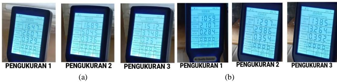
**Gambar 5.** Pengukuran kualitas kimia udara, (a) pengukuran udara masuk (b) pengukuran udara keluar, pada mesin ventilasi udara Mekanik dengan Filter Bio Antibakteri dengan 1 lapis filter.
