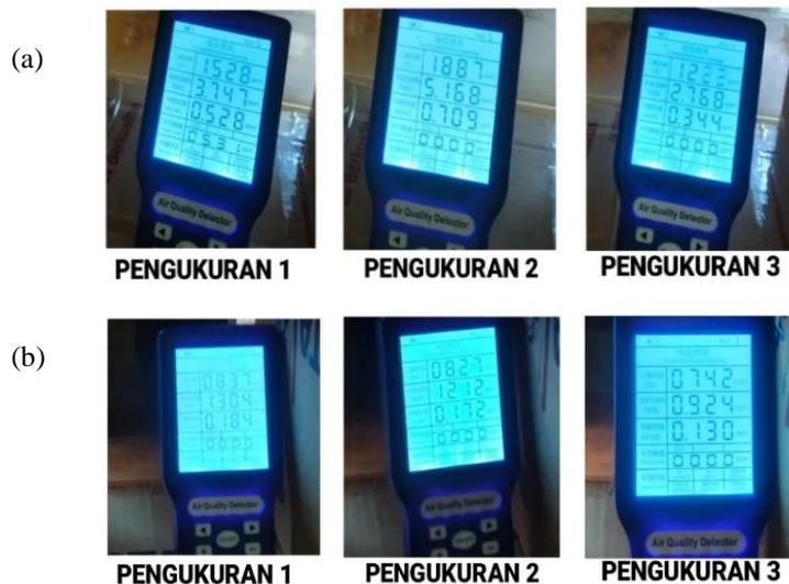
**Gambar 5.** Pengukuran kualitas kimia udara, (a) pengukuran udara masuk (b) pengukuran udara keluar, pada mesin ventilasi udara Mekanik dengan Filter Bio Antibakteri dengan 2 lapis filter.
