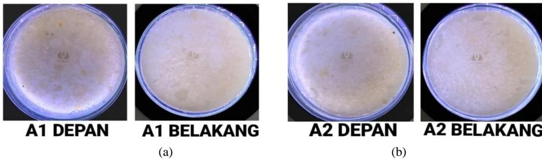
**Gambar 6.** Sampel media agar pada (a) pengukuran udara masuk (b) pengukuran udara keluar, pada mesin ventilasi udara Mekanik dengan Filter Bio Antibakteri dengan 1 lapis filter
