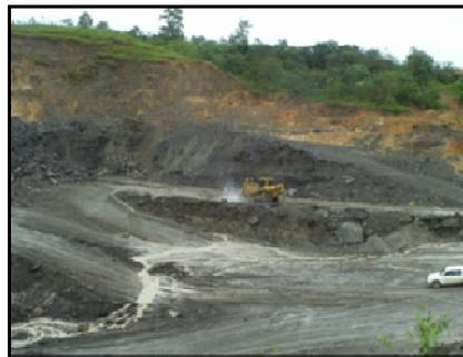
Gambar 5.6 Aliran air di jalan dan lereng tambang
