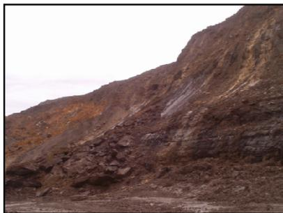
Gambar 4.1 Longsor pada low wall
