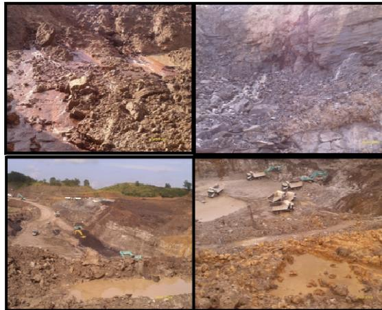
Gambar 5.7 Genangan air dan air yang menembus badan lereng
