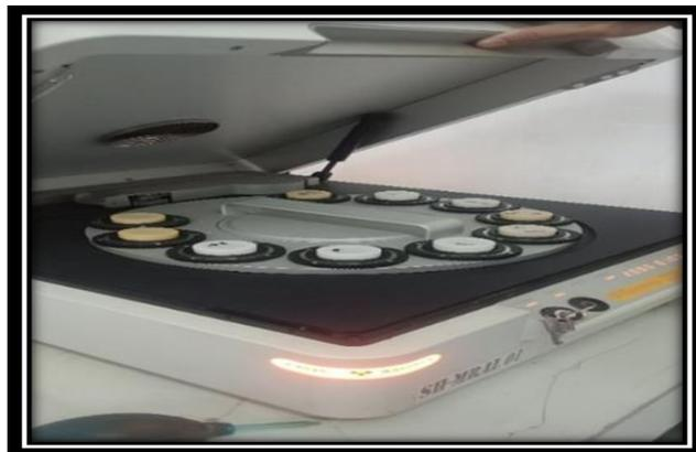
Gambar 6. Mesin X – Ray Type Epsilon 3 Tampak Terbuka
